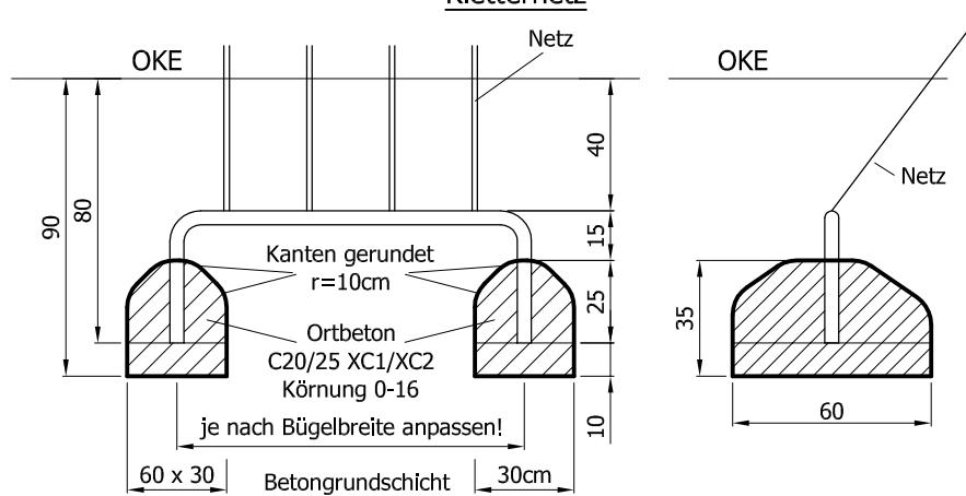
Für den Einbau unserer Geräte mit den angegebenen Fundamentgrößen, ist eine Bodenklasse 3-4 erforderlich.
